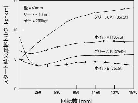
図4-31：油の粘度高と摩擦トルクとの関係
