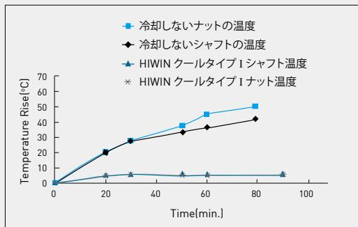
図9.4：クールタイプ I ボールねじ温昇のテスト
