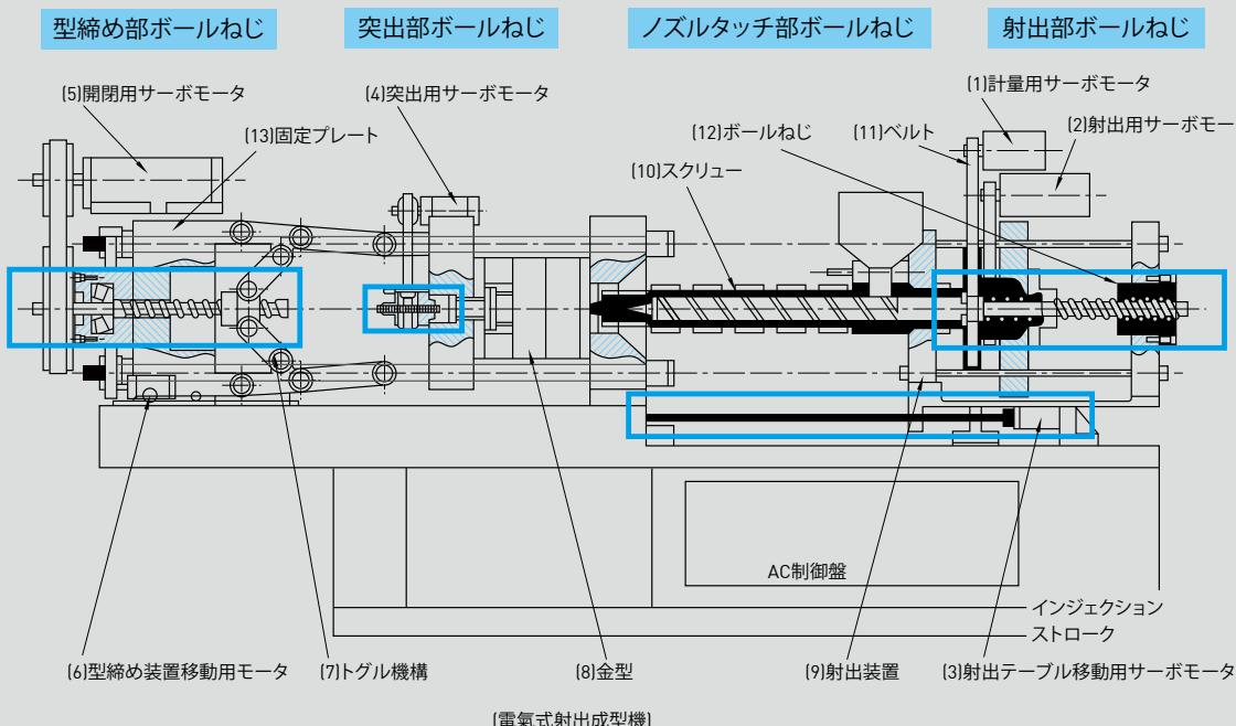
圖2.6 全電式射出成型機構
