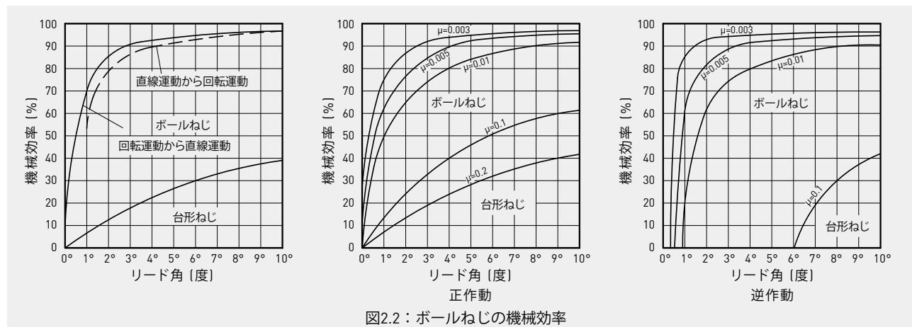
図2.2：ボールねじの機械効率
