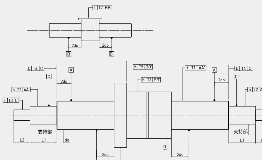
図4-15：HIWIN 精密ボールねじの各部精度
