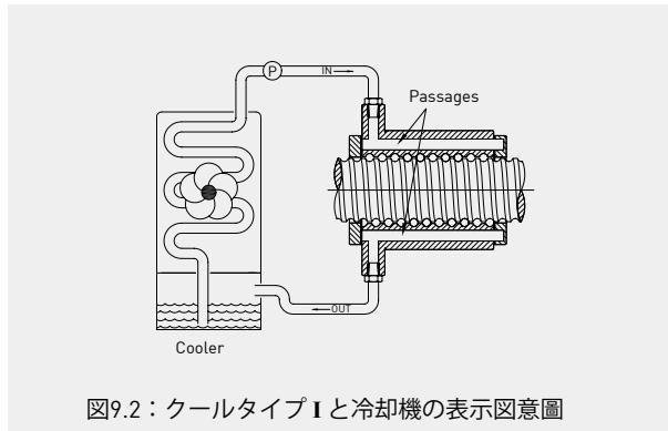
図9.2：クールタイプIと冷却機の表示図意圖
