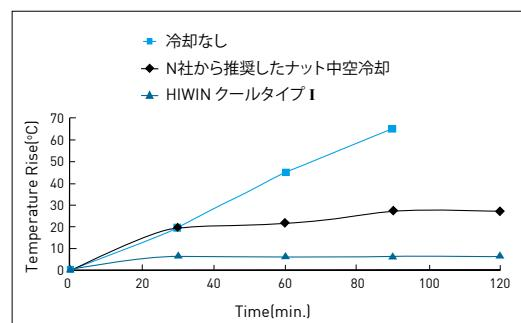
図9.3：高速回転の状況でシャフト中空の冷却した時ボールねじ温昇の比較
