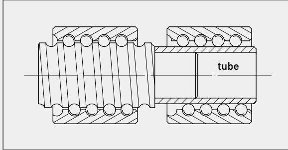
図4-9：ナットとねじ軸の切離しの方法
