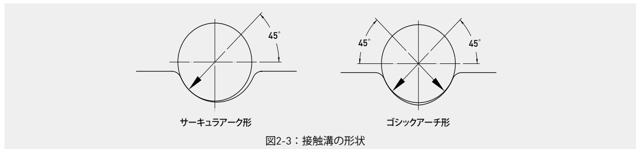
図2-3：接触溝の形状
