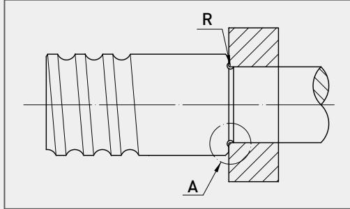
図4-10：ベアリング端面着座の為の面取り
