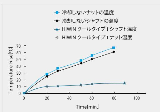
図9.5：クールタイプ I ボールねじ温昇のテスト
