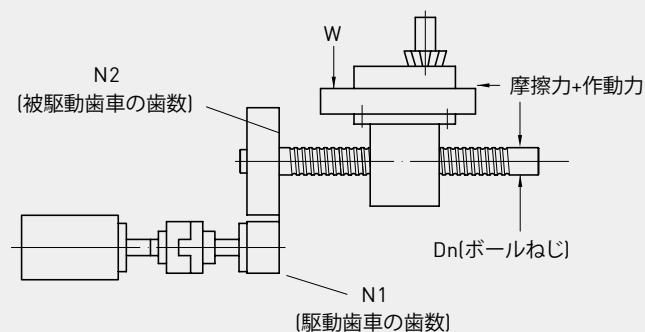
図4-23：ボールねじによる荷重動作
