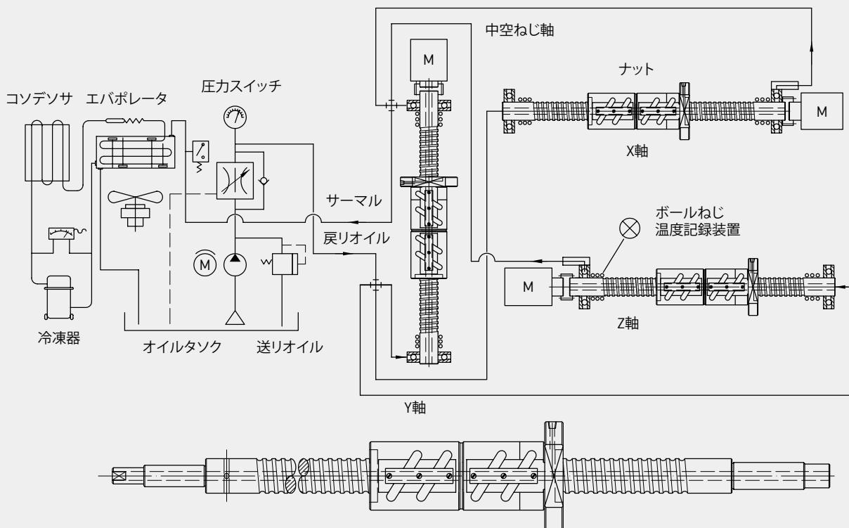
図4-33：中空ボールねじ潤滑法を用いる高精度工作機械
