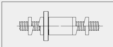
図4-5：ナットのオーバトラベルを防止する為のドッグストップ
