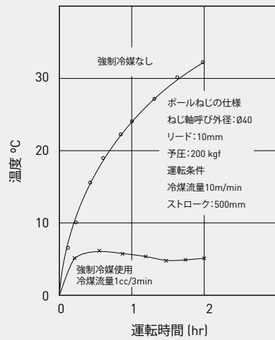
図4-32：冷媒を使用する場合と使用しない場合のボールねじの昇温の比較
