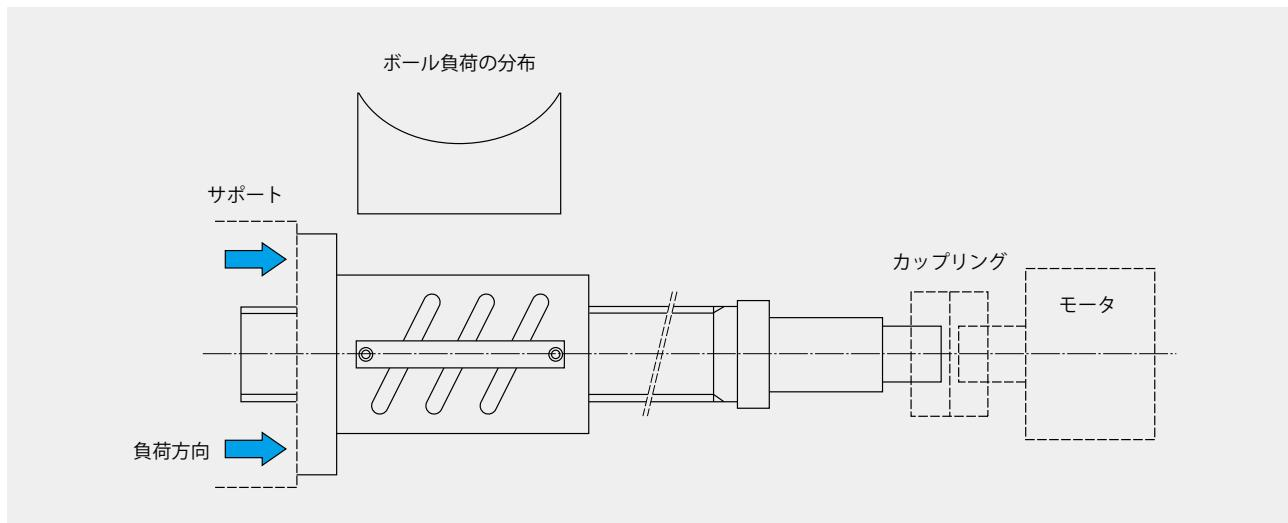
ナット内部の負荷を平均する為に、ボールねじの組付けは上図の様にお提案します。そうすると各リターンチューブの負荷は均一にする。一部ボールが過激磨耗の現象を発生しない、有効的にボールねじの寿命を延長します。
