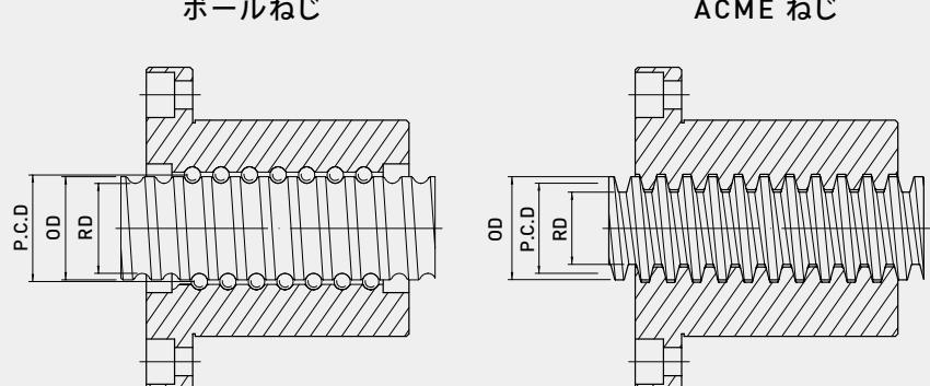
図2.1：ボールねじと台形ねじ(ACMEねじ)の基本形式の比較
