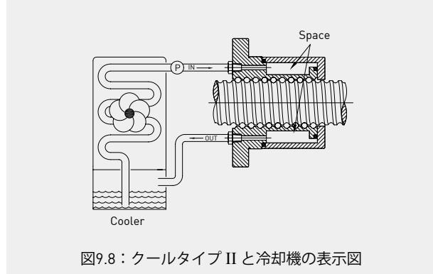
図9.8：クールタイプ II と冷却機の表示図
