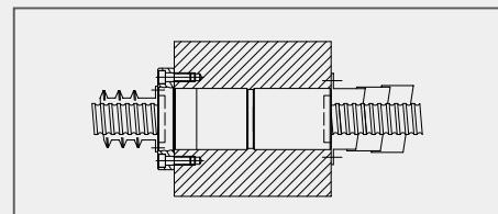
図4-6：テレスコピック又はベローズタイプカバーによるボールねじの防護
