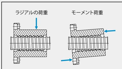
図4.2(a)：取付誤差の影響本図はボールねじの支持部(ねじ軸、支持軸受、案内など)の取付が一直線になっていない時、偏荷重が加わると、作動性に悪影響を及ぼします。
