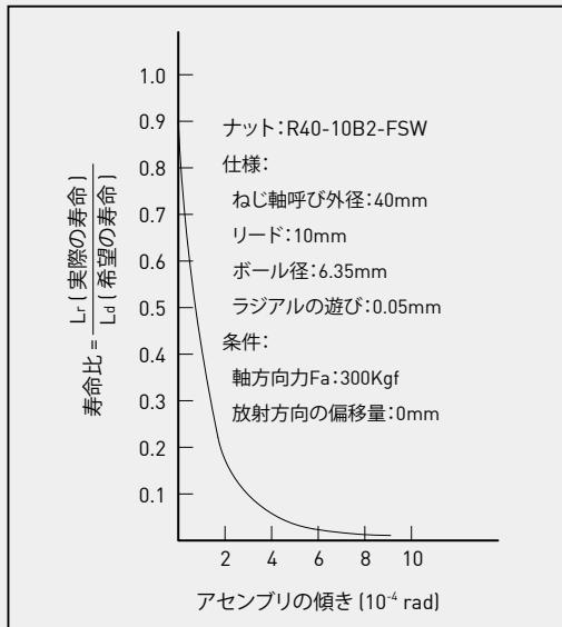
図4.2(b)：ラジアル荷重による疲れ寿命の影響
