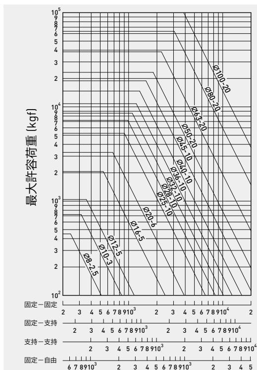
図4-25：ねじ軸呼び外径および長さに対比された座屈荷重を示す。
