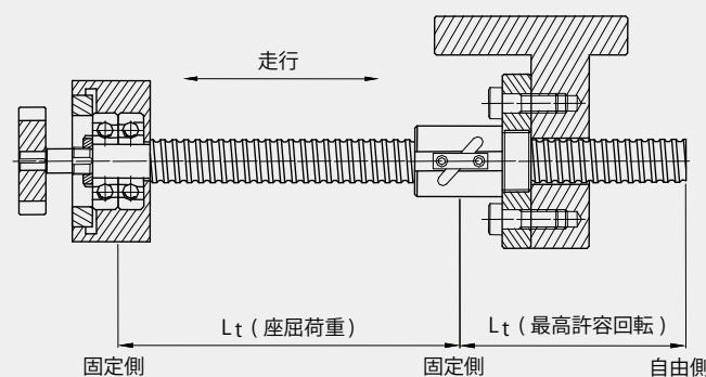
図4.27 ボールねじを取り付け実例
