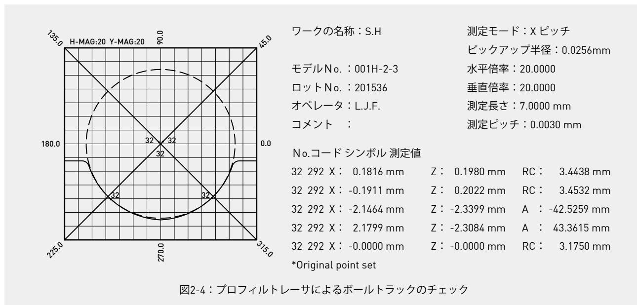
図2-4：プロフィルトレーサによるボールトラックのチェック
